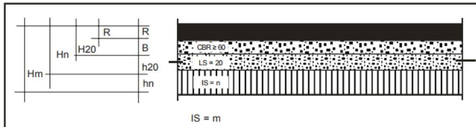
Para os casos em que  $N \leq 10^6$  admite-se o Tratamento Superficial Duplo (TSD), aonde as camadas regulares ou reperfilamento, devem ter a espessura por camada de até 1,5 x a dimensão do maior agregado componente do traço, sendo assim, para os casos do “*Procedimento Simplificado Para Pavimentação Urbana*” em que irá ser utilizado Pedra Britada N° 2 sua camada de revestimento será de  $1'' = 2,5$  cm.
