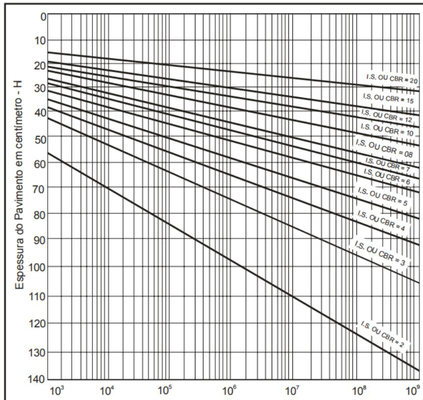
O Ábaco apresentado fornece a espessura total do pavimento, em função de N e de I.S. ou C.B.R.; a espessura fornecida por este gráfico é em termos de material com  $K = 1,0$ , isto é, em termos de base granular. Entrando-se em abscissas, com o valor de N, procede-se verticalmente até encontrar a reta representativa da capacidade de suporte (I.S. ou C.B.R.) em causa e, procedendo-se horizontalmente, então, encontra-se, em ordenadas, a espessura total do pavimento.
