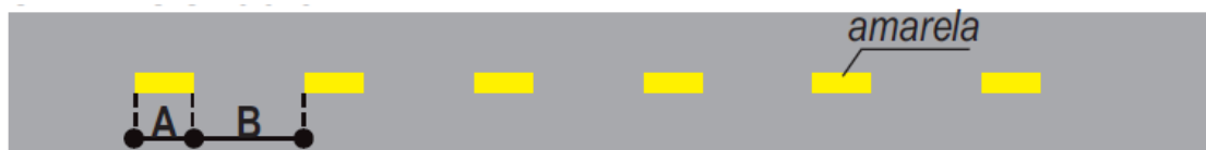
Detalhe Faixa Seccionada.
