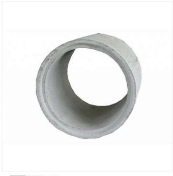
Os tubos de concreto são peças circulares pré-moldadas de concreto, com encaixe macho e fêmea ou ponta e bolsa. São utilizados em galerias de águas pluviais, drenagem de aeroportos e rodovias, galerias e bueiros. TAMANHO: 0,80m (diâmetro) X1,00m (altura) X 0,10 (espessura) > PESO: 800kg
